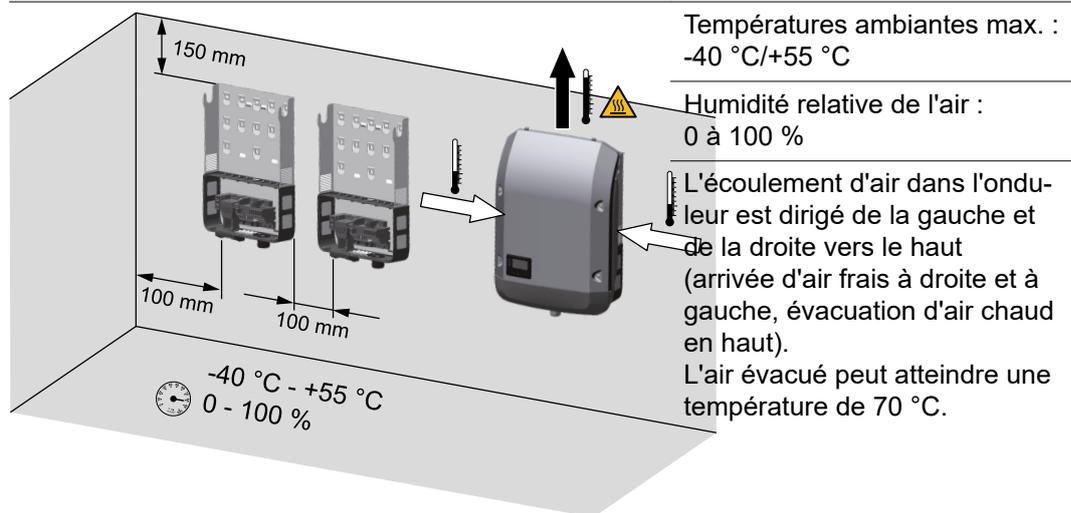
Dans le cas d'une installation d'onduleur dans une armoire de commande ou dans un local fermé similaire, assurer une évacuation suffisante de l'air chaud par une ventilation forcée.
