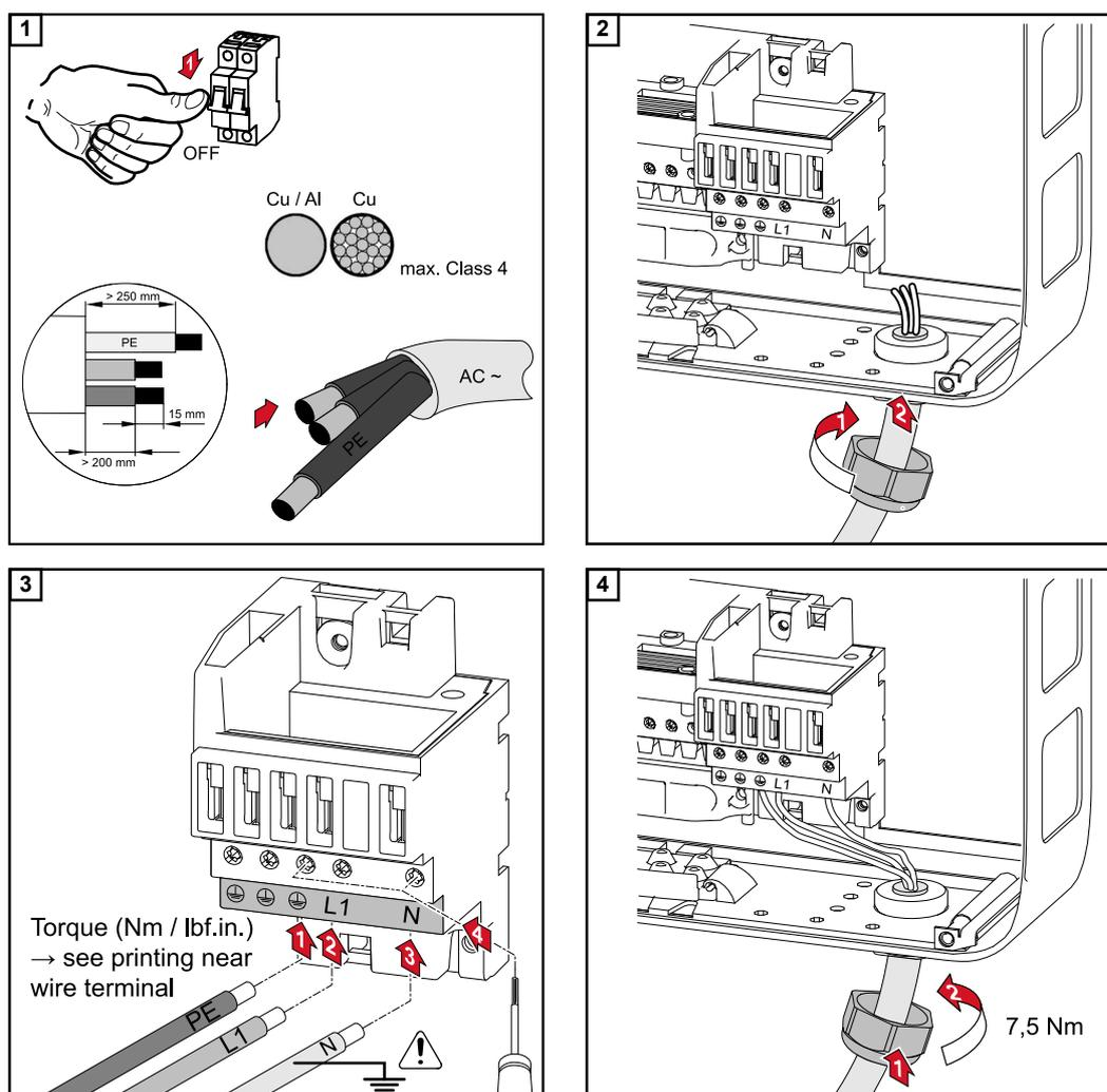
**REMARQUE !** Respecter les indications de couple imprimées sur le côté inférieur des bornes de raccordement !
