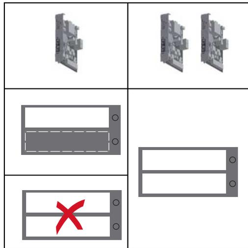
**IMPORTANT !** Lors de l'installation du Datamanager dans l'onduleur, ne briser qu'un seul évidement pour le circuit imprimé.
