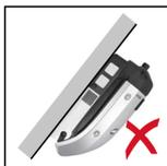
L'onduleur ne doit pas être monté en porte-à-faux avec les connecteurs vers le bas.
