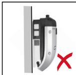
L'onduleur ne doit pas être monté en porte-à-faux avec les connecteurs vers le haut.
