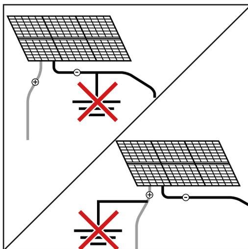
L'onduleur est exclusivement conçu pour le raccordement et l'utilisation avec des modules solaires non mis à la terre. Les modules solaires ne doivent être mis à la terre ni au pôle positif, ni au pôle négatif.
