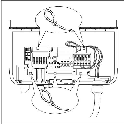
Si des câbles AC ou DC trop longs sont installés en boucles dans la zone de raccordement, ils doivent être fixés aux œillets prévus à cet effet sur les côtés inférieur et supérieur du bloc de raccordement, au moyen d'attache-câbles.
