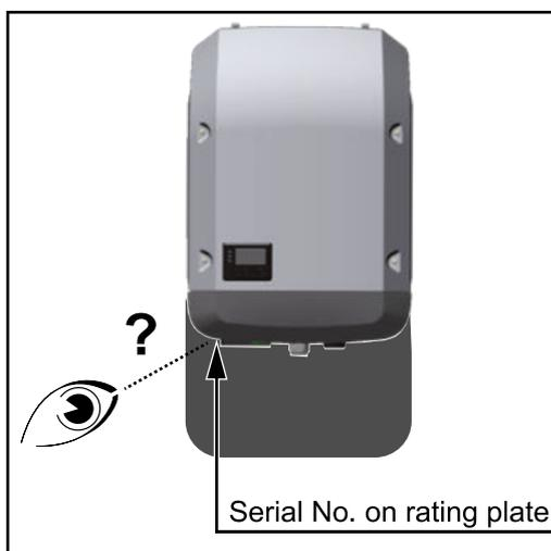
Le numéro de série de l'onduleur se trouve sur la plaque signalétique au niveau de la partie inférieure de l'onduleur. En fonction de la position de montage, le numéro de série peut être difficilement accessible ou difficile à lire, par exemple lorsque l'onduleur est monté dans un endroit sombre.
